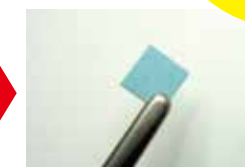
変色は見られず、乾燥が完了している事を確認
