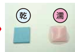
水分が付着すると変色する乾燥インジケータのサンプルを使用した
